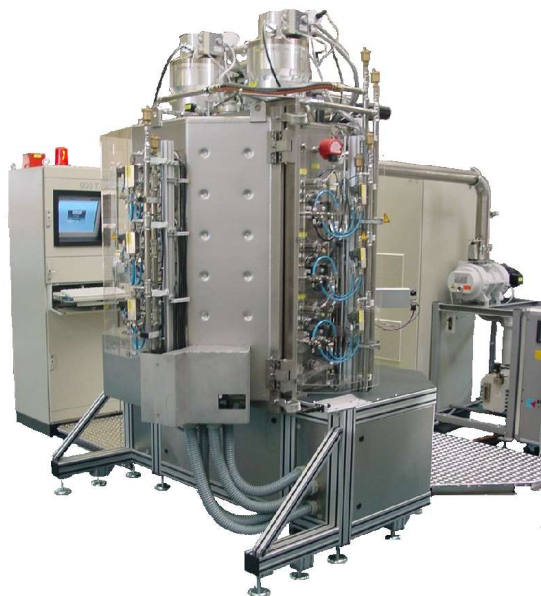
Rys. 3. Urządzenie do nanoszenia warstw typu TiN. Na komorze procesowej umieszczone są dwie pompy turbomolekularne TPH 2101. Próżnia wstępna wytwarzana jest przez stanowisko pompowe: pompa olejowa łopatkowa i pompa Rootsa
